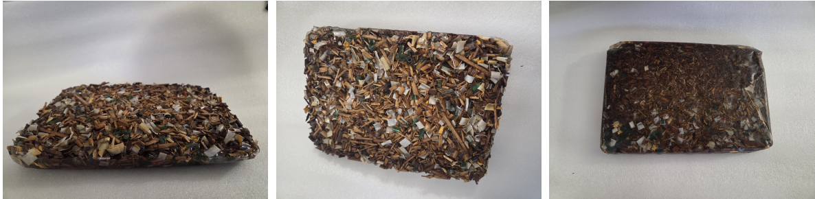
FIGURE 4.1 – Photo de la planche, après cuisson et application de la résine d'époxy
