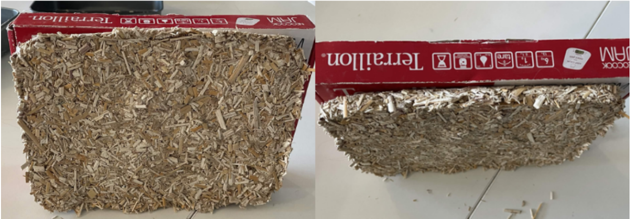
FIGURE 6.3 – Planche fabriquée avec de la colle à base d'amidon, vue de face et de dessus.
