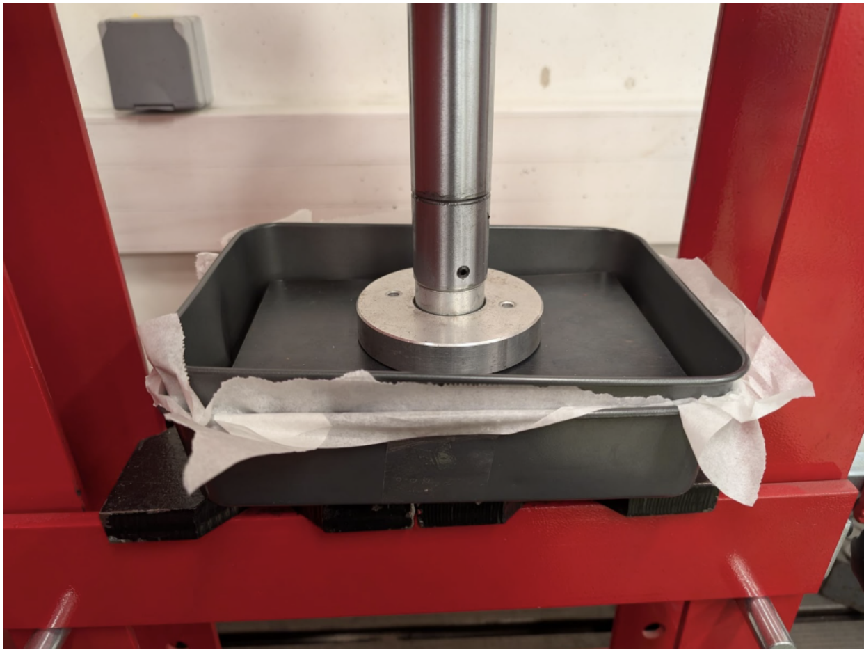
FIGURE 6.1 – La presse de la fabrique en action : par dessus le miscanthus, nous ajoutons un moule, une planche en metal et deux blanches en bois pour répartir la charge de la presse
