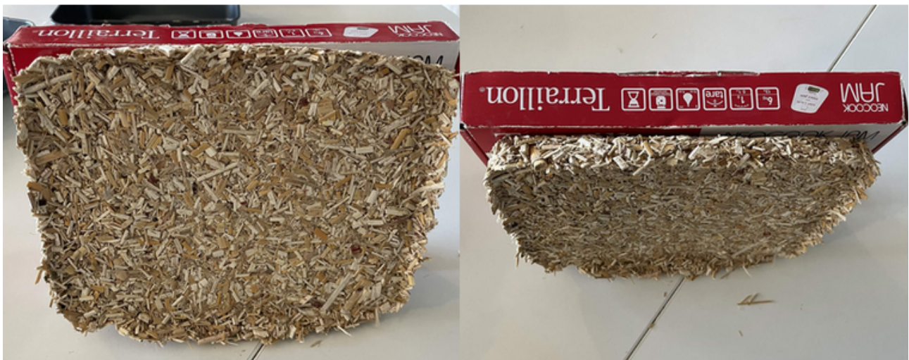
FIGURE 6.2 – Planche fabriquée avec de la colle à bois, vue de face et de dessus.
